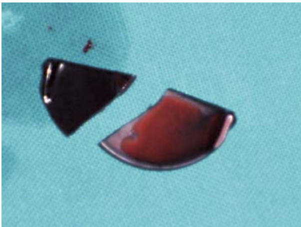
Εικόνα 4. Απεικονίζονται τα δυο αποσπασθέντα τμήματα της βαλβίδος.
