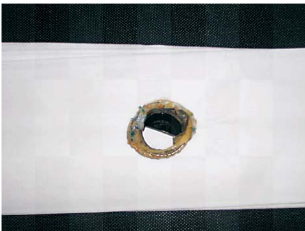
Εικόνα 1. Η προσθετική βαλβίδα Duromedics όπως αφαιρέθηκε μετά την απόσπαση του προσθετικού φύλλου.
